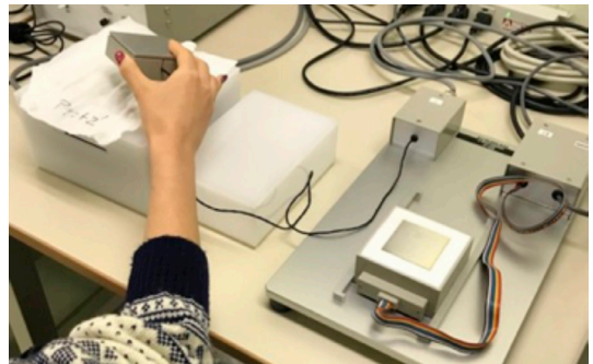
風合い計測システムでの紙おむつの接触冷感の測定
